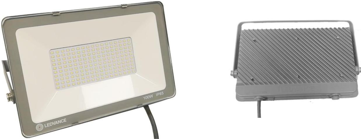
LEDVANCE® 铂漾 LED 泛光灯是一款压铸铝，稳定的产品。产品完美替换传统泛光灯，造型更简洁，调节方式更方便，更高效的光效输出。整个系列有 5 种不同尺寸。线性电源设计配合压铸铝散热系统。保障更高效的使用寿命和输出，替换传统高压钠灯和陶瓷金卤灯及卤钨灯。产品更节能，减少维护成本。IP65 防护等级和 IK06/IK08 的抗震等级适应不同的户外环境。
