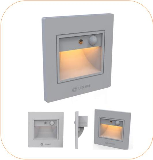
LEDVANCE®锐皓LED地脚灯是一款外观简洁，功能丰富的室内氛围照明产品。智能识别、人体感应、延时熄灭、超低功耗是这个产品的最主要特点，标准的86x86的开孔尺寸，适配市场标准安装底盒，无论是新装，还是旧品替换，都可兼容。2.5米的最大感应距离，90°大感应角度，满足实际客户实际应用需求。方正的外框简洁，隐藏的出光护眼。锐皓LED地脚灯是一款性能齐全，价格实惠的好产品。
